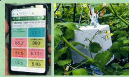
スマホで確認 モニタリング装置 気温、湿度、CO 2 濃度、日射量等がリアルタイムにスマホで確認
