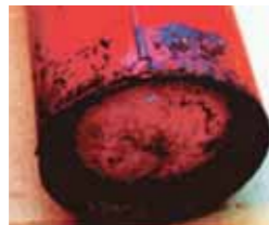
消火器底部の腐食
