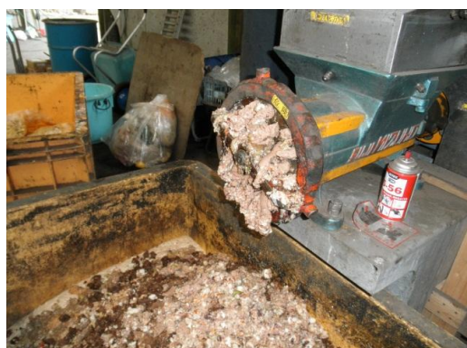
破砕機を使用し生ごみをペースト状にします (1時間当たりの処理量は約350kg。)
