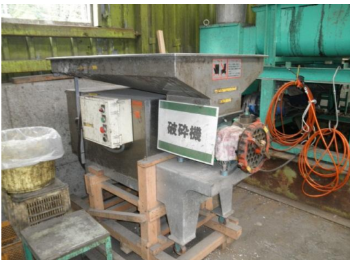
破砕機を使用し生ごみをペースト状にします (1時間当たりの処理量は約350kg。)
